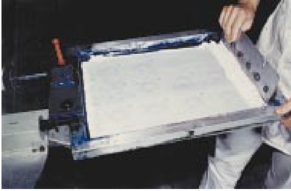
Fig. 3: Adhesive printing (Tubi trans. CHT).
