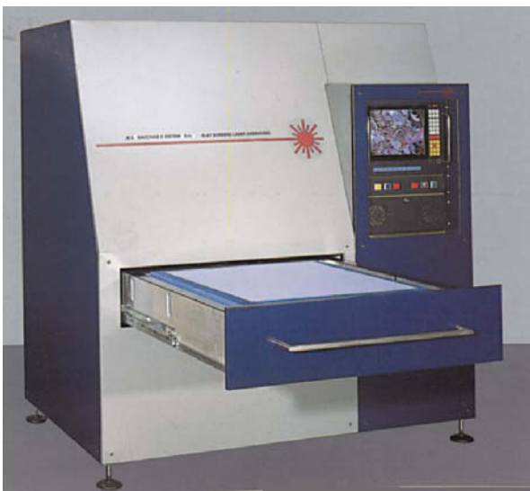
Fig. 5: Flat screen laser engraving (M. S.).
