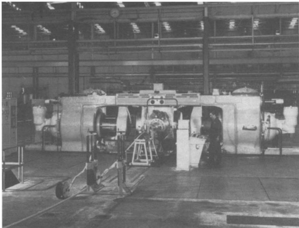
Fig. 25.9 Schloemann aluminium sheathing press
