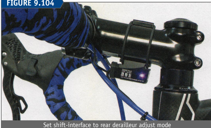
Set shift-interface to rear derailleur adjust mode
