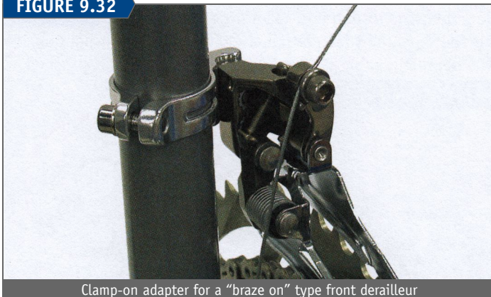
Clamp-on adapter for a “braze on” type front derailleur
