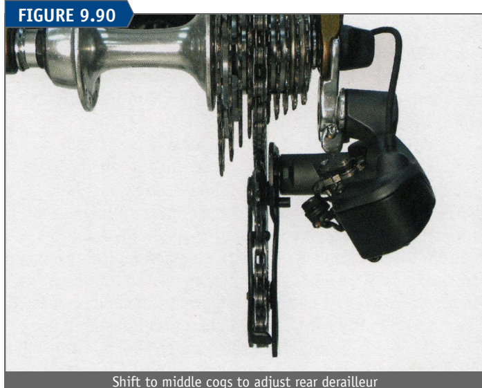
Shift to middle cogs to adjust rear derailleur
