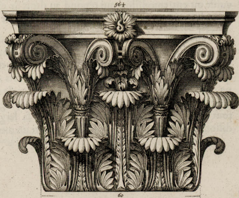
Chapiteau des pilastres
