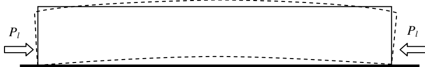
Figura 5.4 – Contrasăgeată a elementului sub acțiunea precomprimării la transfer
