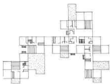
Fig.21.2 Elemente spațiale. Turnate pe platformă orizontală. Tipuri. Asamblare.
