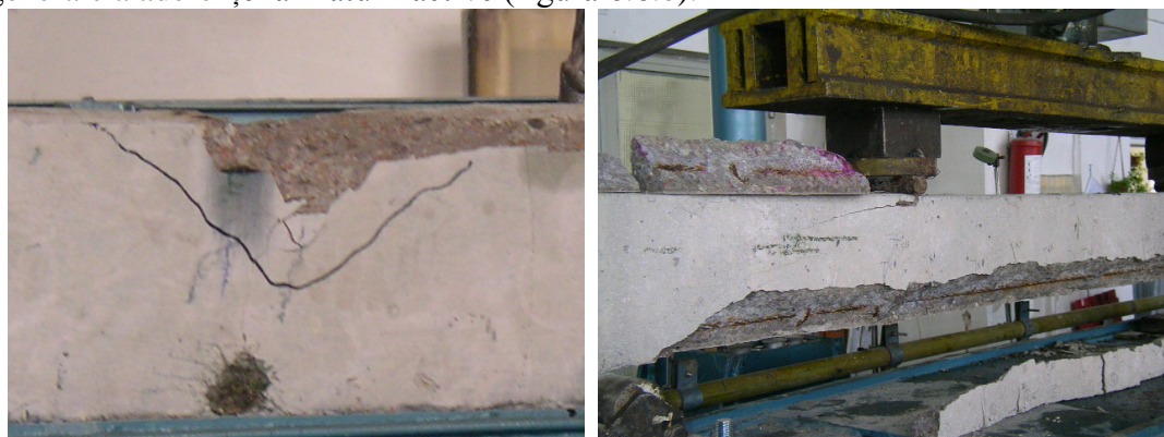
a. prin încovoiere b. prin pierderea generală a aderenței Fig. 6.6 Moduri de cedare ale elementelor precomprimate
