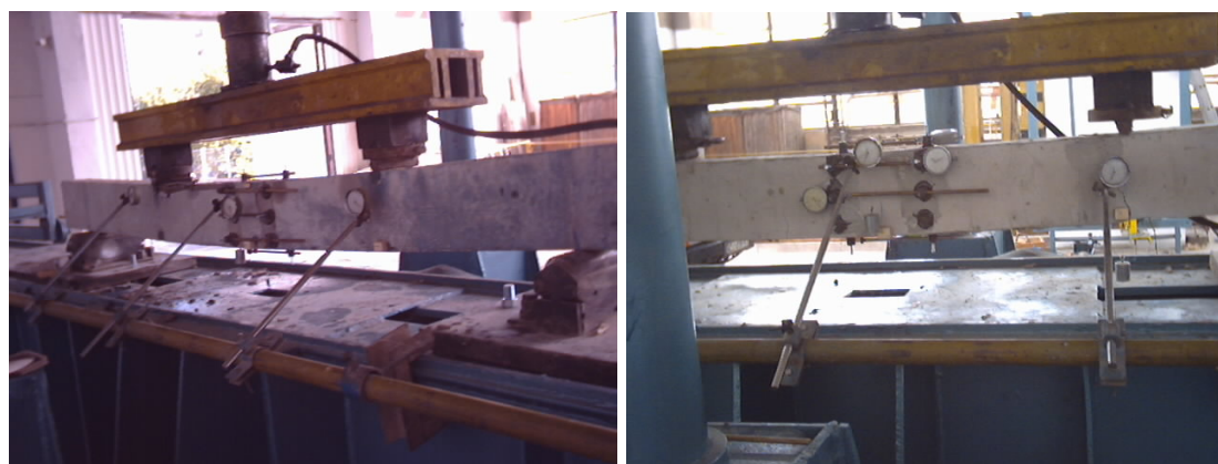
Fig. 6.3 Încercarea la încovoiere a elementelor depozitate în medii industriale agresive
