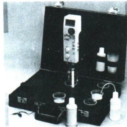
Fig. V.21. Analizor de ioni cu electrod specializat și trusa pentru determinări in situ (firma RADELKIS)
