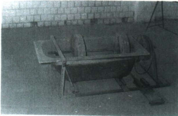
Foto V.25. Cuvă pentru încercări la coroziune accelerată a armăturilor prin rotirea alternativă în soluție și în aer
