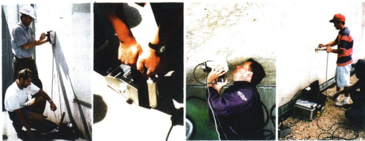
Foto V.4. Încercarea elementelor prin metoda ecoului de impact și aparatura de încercare (firma GERMANN INSTRUMENTS)
