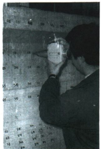
Foto V.13.c. Aplicarea metodei sclerometrării
