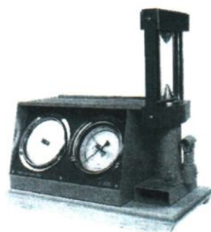
Foto 11.b. Presa de încercare punctiformă in situ a carotelor mici și a probelor cu geometrie neregulată (firma CONTROL)
