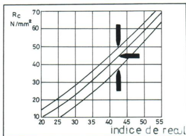
Fig. V.11. Curba de calibrare pentru sclerometrul Schmidt de tip P
