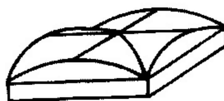
Fig. VI.9 Acoperiș sub formă de boltă romană
