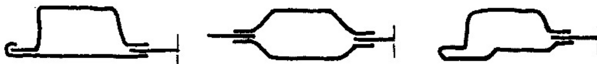
Fig. VII.42 Alcătuirea ușilor metalice din tablă presată
