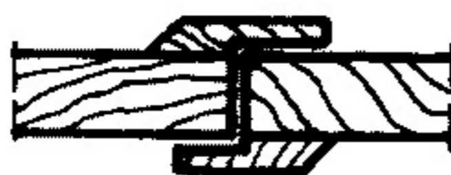
Fig. VII.40 Îmbinarea canaturilor cu șipci de lovire
