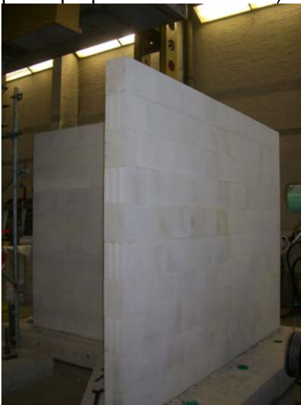
Figura: perete cu sectiune T inainte de testare/ fundat pe grinda de beton prefabricata
