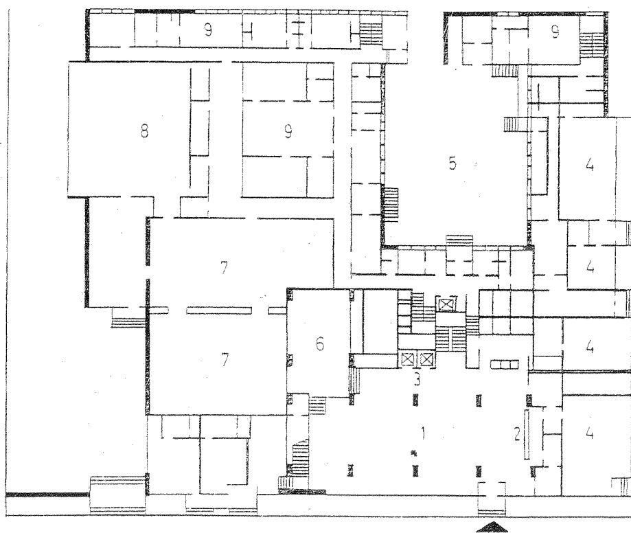
Plan parter: 1 — holul principal; 2 — recepția; 3 — ascensoare; 4 — magazine; 5 — curte de serviciu; 6 — bar; 7 — restaurant; 8 — braserie; 9 — servicii.
