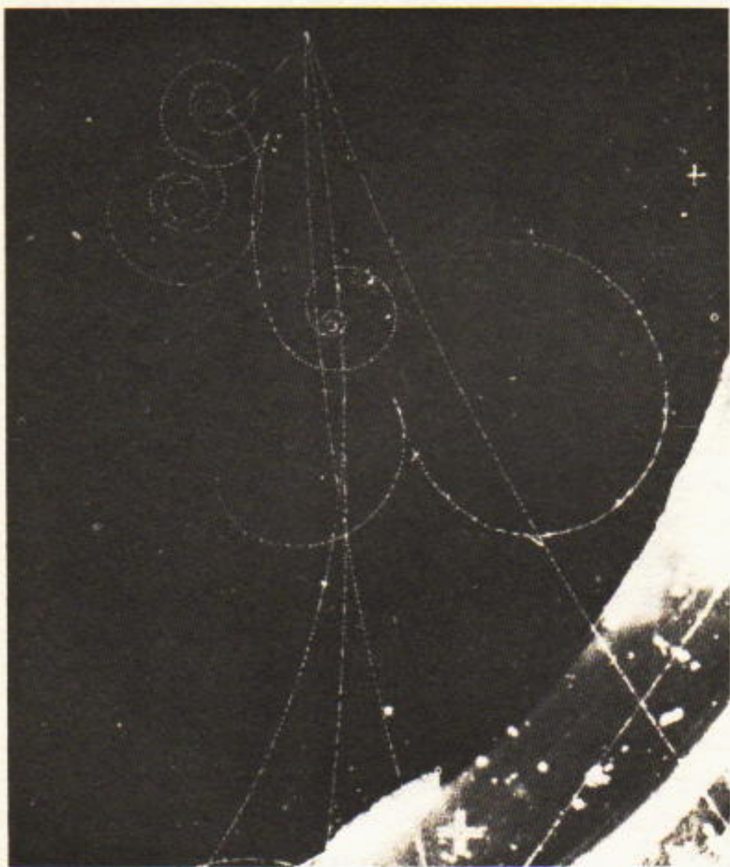
Τροχιές στοιχειωδών σφαιριδίων μέσα σε θάλαμο φουσαλίδων
