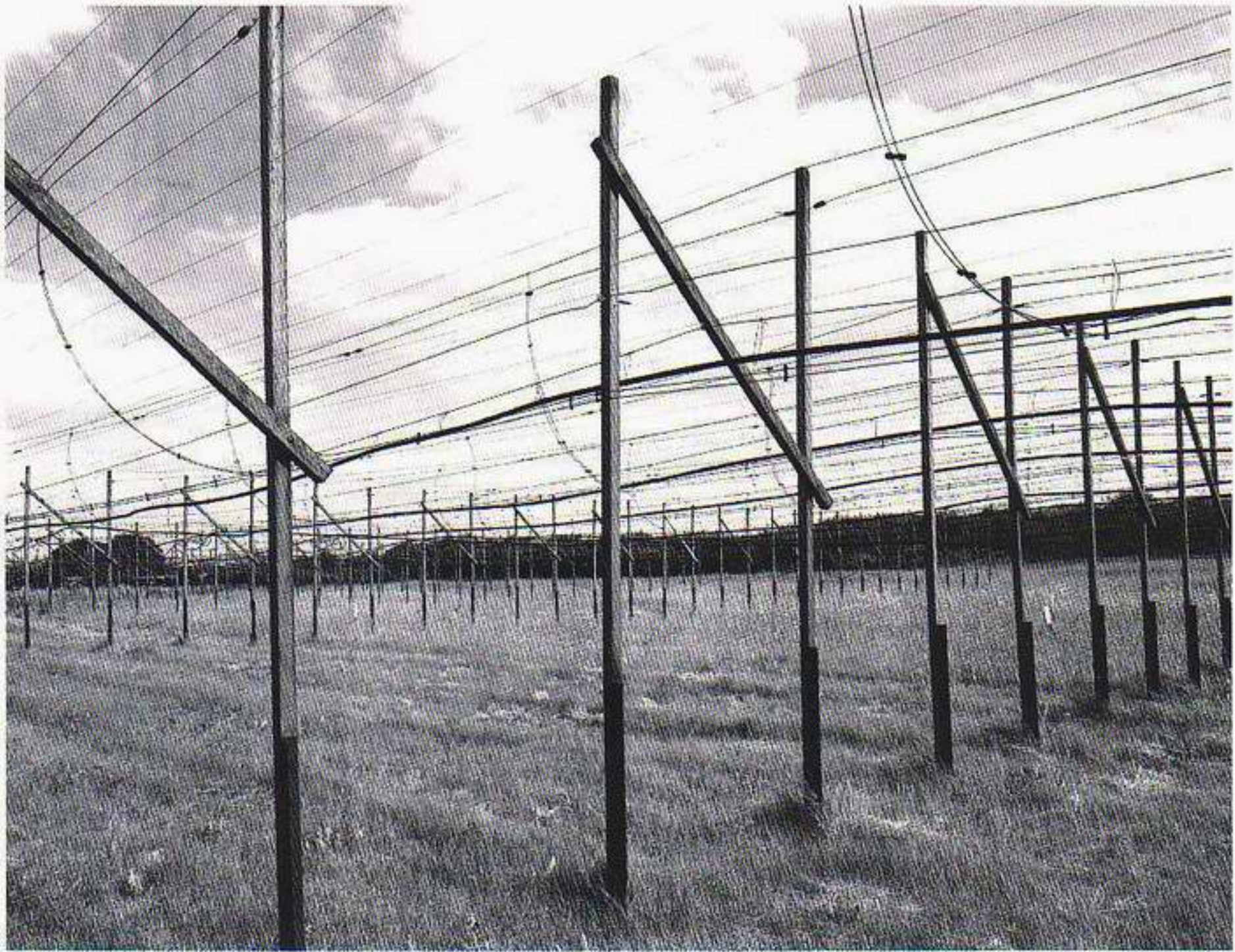
Εικόνα 10.12 Περισσότερες από 2.000 διπολικές κεραίες απάρτιζαν το ραδιοτηλεσκόπιο με το οποίο ανακαλύφθηκαν οι πάσσαρ. Οι ξυζές ράβδοι στηρίζουν ένα ανακλαστικό πλέγμα που αυξάνει την ευαισθησία της διάταξης. Αρχικά το όργανο προοριζόταν για τη μελέτη των αναπόσβεων διάφορων ραδιοπηγών του μεσοαστρικού διαστήματος.
