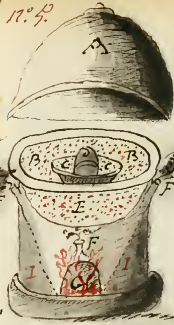
Figure 5. Fourneau de terre philosophique dont le degré de chaleur peut aller jusqu'à flut de plomb
