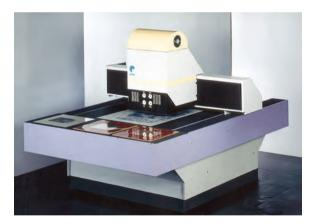
Fig. 3.1-49 Step-and-repeat copying machine (Krause-Biagosch)
