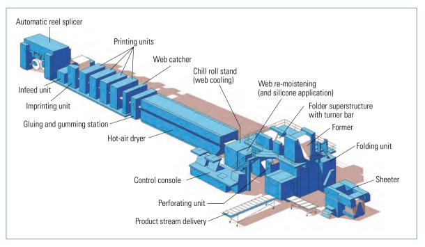
Fig. 2.1-77 Web offset press components (M-600, Heidelberg)
