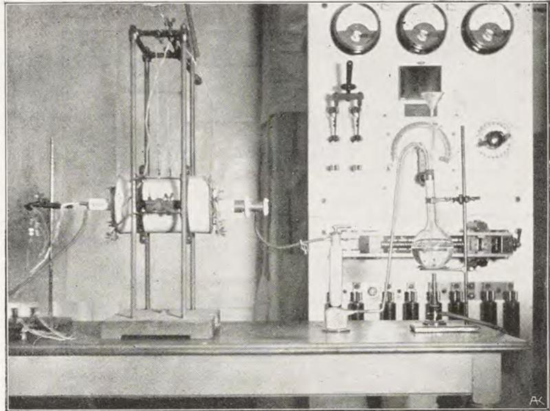
Fig. 2. Elektrischer Widerstandsofen.
