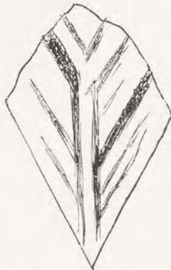
Figur 6. Beim Thermitverfahren entstandener Rubin. Nach F. Rinne.
