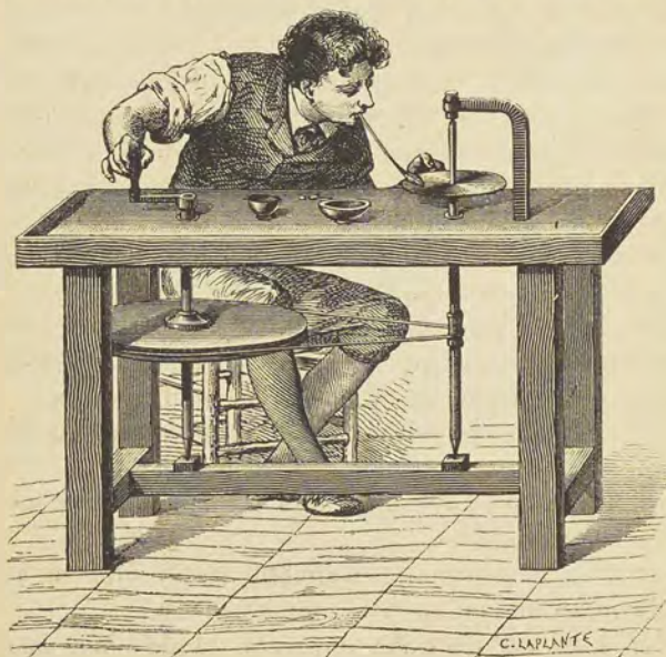
Fig. 130.—Aparato para aserrar las piedras duras.
