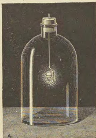
Fig. 33.—Combustion del diamante en el oxígeno.
