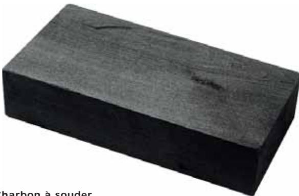
Charbon à souder Pour éviter la casse, le serrer avec du fil de fer ou du laiton Charcoal for soldering To be tightened with iron or brass wire to do not break 140 x 70 x 30 mm
