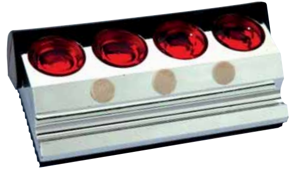
Huilier 4 godets en verre anti-hygométriques permettant de stocker les huiles et les graisses 1 couvercle noir anti-poussière, 3 trous garnis de moelle de sureau pour le nettoyage des pique-huile, 1 rainure pour poser 1 pique-huile, un socle antidérapant.
