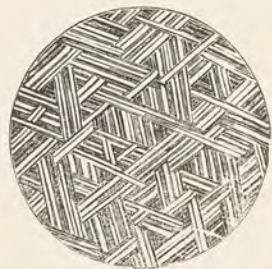
Obr. 15. Obrazy Widmanstättenovy na povětronním železe, které bylo leptáno kyselinou dusičnou.
