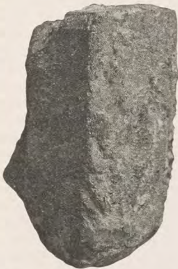
Fig. 1. Großer Hellanditkrystall 1/1 . Links (\bar{1}00) , dunkel; rechts (0\bar{1}0) und (\bar{3}20) ; oben (201) , (\bar{1}02) und (\bar{1}03) , (groß).
