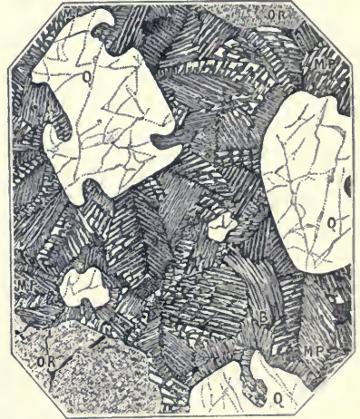
Fig. 6. — Microgranulite de l'Allier vue à un grossissement de 150 diamètres. On voit les grands cristaux de quartz rongés sur les bords (Q), d'orthose (OR), et de biotite (B), dans un milieu cristallisé à éléments plus petits, où domine la micropegmatite (MP).
