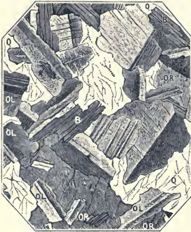
Fig. 5. — Granite de l'Allier vu à un grossissement de 30 diamètres. On voit les cristaux enchevêtrés d'orthose (OR), d'oligoclase maclé (OL), de quartz avec lignes d'inclusions (Q), de biotite ou mica noir (B).
