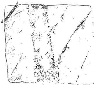
b Bleiglanz, p Pyrit, q Quarz, z Zinkblende. Der Gang steht mit Trümmern in Verbindung, welche anfänglich mit diesen Mineralen gefüllt sind, weiterhin aber bei k Drusen von Quarz, Calcit, Braunspath enthalten.
