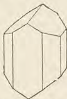
Fig. 71. Kombination von Vertikalprisma, Querfläche, Längsfläche und Längsprisma. Augit.
