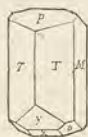
Fig. 72. Kombination von Vertikalprisma(T), Längsfläche (M), Basis (P), zwei hintern Schiefendflächen (x, y) und einer hintern Pyramide (o). Feldspat.
