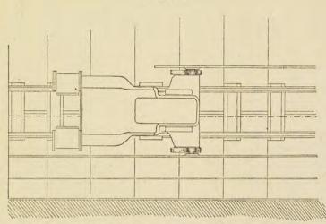
La machine horizontale est aussi installée en face du gradin à découper; lorsqu'on a à faire des entailles à côté des parois de la galerie, il faut toujours pratiquer une excavation de 0,40 avec le pic, pour installer la voie de roulage sur laquelle doit circuler la machine horizontale.
