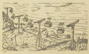
Le wagonet chargé circule sur un câble en acier de 0<sup>m</sup>,031 de diamètre et de 2200 mètres de longueur; arrivé à la gare, il est
