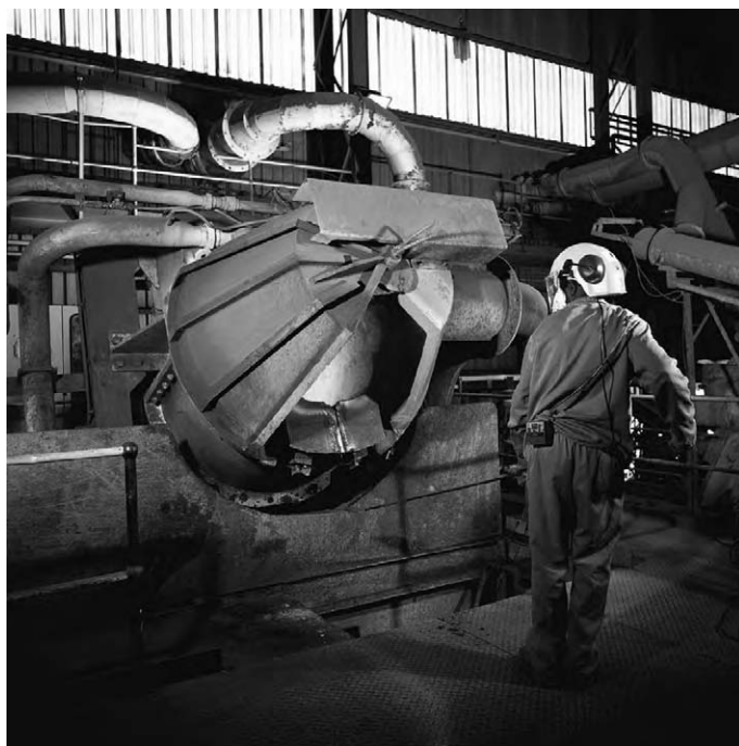
Fig. 11. Preparing to pour doré from the bottom-blown oxygen converter.
