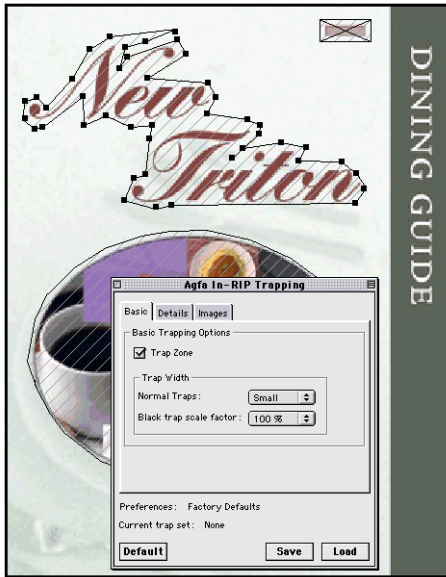
Abb. 6.5 (links) Trapping-Zonen im Acrobat-Plugin Agfa In RIP Trapping
