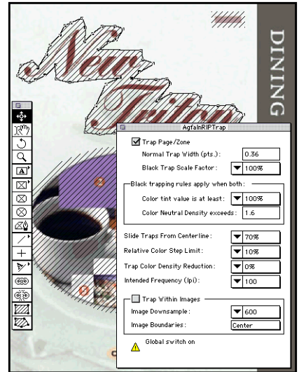
Abb. 6.5 (rechts) Trapping-Zonen in Quark XPress mit der Agfa In RIP Trapping XTension
