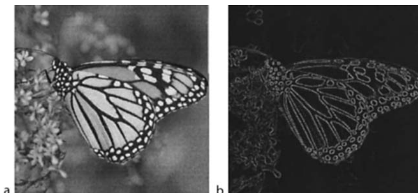
Edge Detection. Figure 1. Color edge detection: (a) color image, (b) corresponding edge map.
