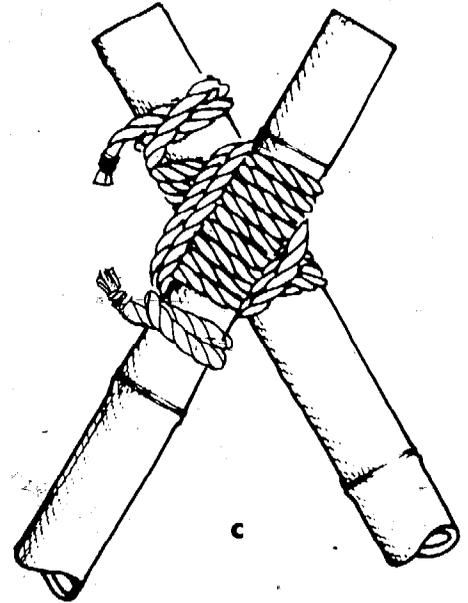
Primer método: Se comienza colocando los dos bambúes paralelamente. Se amarra un extremo de la cuerda en un bambú y luego se envuelven los dos con lazadas horizontales (ver. fig. a) que no deben tensionarse demasiado para que permita luego separar los extremos inferiores hasta la distancia deseada. Posteriormente se le dan dos o tres lazadas verticales amarrando luego el extremo libre de la cuerda en el bambú contrario al que se le hizo el primer nudo.
