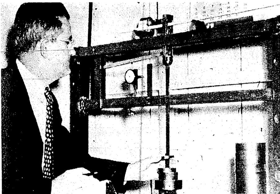
Aparato especialmente diseñado para medir la deflexión producida por una carga aplicada en el centro de tablillas de bambú.
