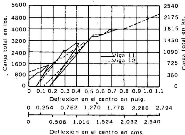
Fig. C Carga típica versus deflexión en el centro.
