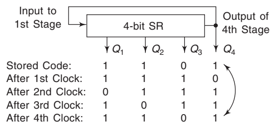
Fig. 13.10 Recirculating Shift Register.
