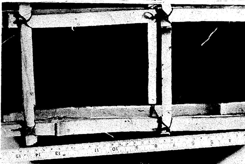
*Figura 5-32. Armadura con refuerzo de tablillas colocadas verticalmente.*
