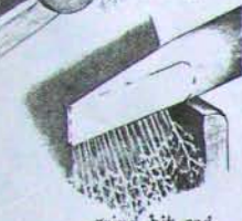
grind bit end till cherry red & quench
