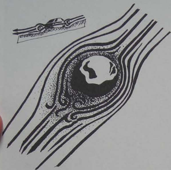
Fig. A1.12. Scour hole
