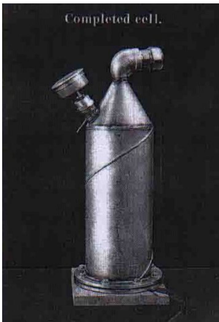
Fig.1 – Une vue de la "Old Trusty". Une pile de trois ans d'âge qui brise la plupart des règles de conception de pile, mais qui est toujours une grande artiste. Une jauge de pression temporaire est installée dans le trou de remplissage pour surveiller les fuites d'air.
