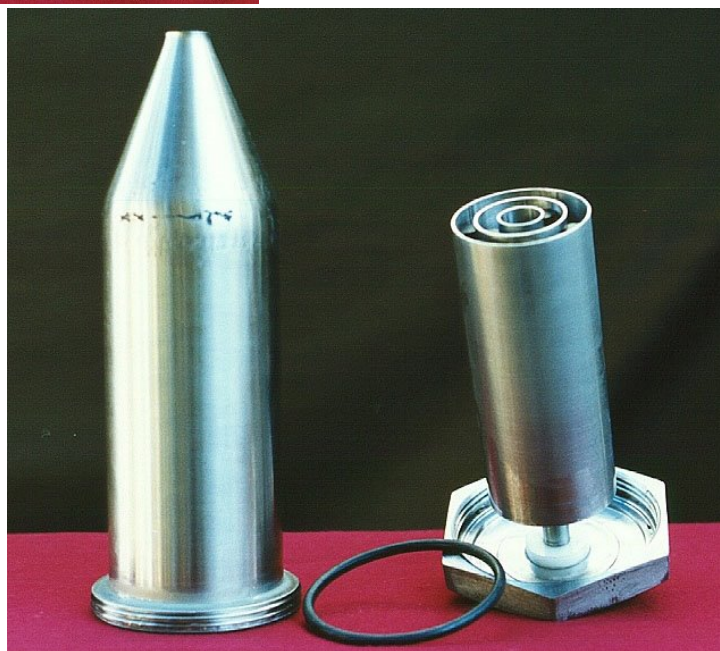
Fig.16 – Pile, 4 cylindres. Vue des sous-ensembles complétés de la pile. Notez que la bague de compression est manquante au sommet du cône. Le joint torique s'insère entre le filetage externe et le couvercle de base.
