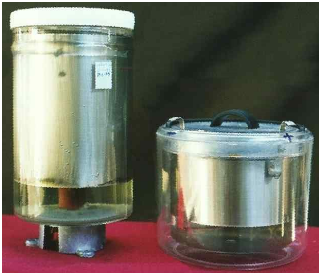
Fig.3 – Deux types de piles de test. Sur la gauche, une pile en verre avec une connection négative par un trou percé dans le fond. Sur la droite, une pile en plastique avec les deux connections localisées en haut.
