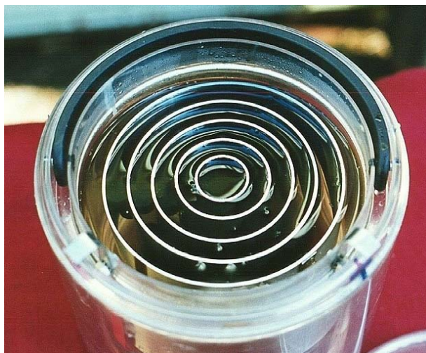
Fig.32 – Stade 2. Une vue après 24h. Remarquez que la pile est maintenant morte (pas de bulles, pas de tension de surface).
