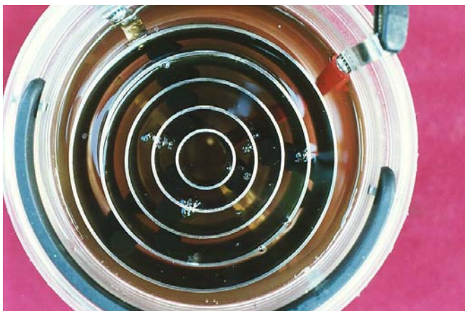
Fig.31 – Stade 2. Une vue après 1 minute avec le courant coupé. Remarquez l'absence de bulles résiduelles.
