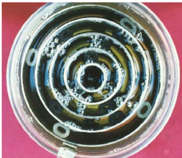
Fig.38 – Stade 3. Une vue 2 jours après extinction du courant. La pile est toujours vivante et quelques bulles sont encore visibles. Seule une pile générante fera ça.
