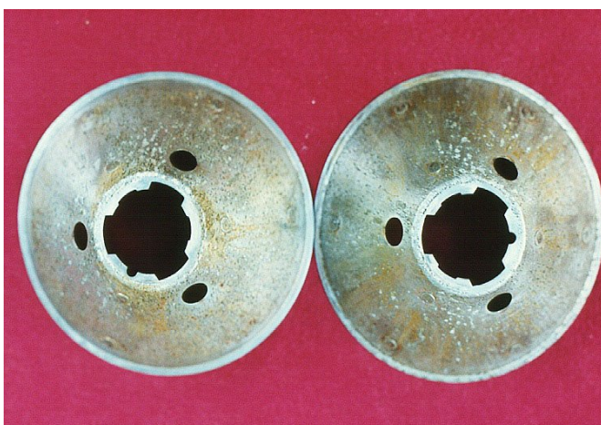
Fig.4 – Cône de la cuve de chargement. Ceci est le résultat de l'utilisation de plus de 10 Amps sur le longues périodes. Notez le grave piquage. Ces cônes ne sont plus que de la ferraille maintenant.
