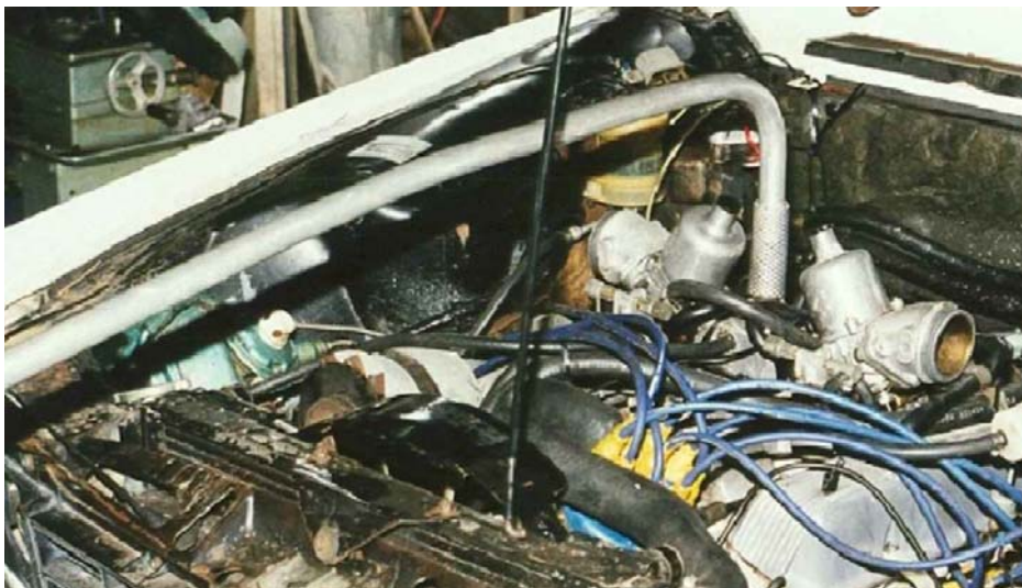
Fig.48 – Une vue du moteur Rover utilisé dans le test, montrant le tuyau s'étendant de la pile externe et connecté au collecteur d'admission.
