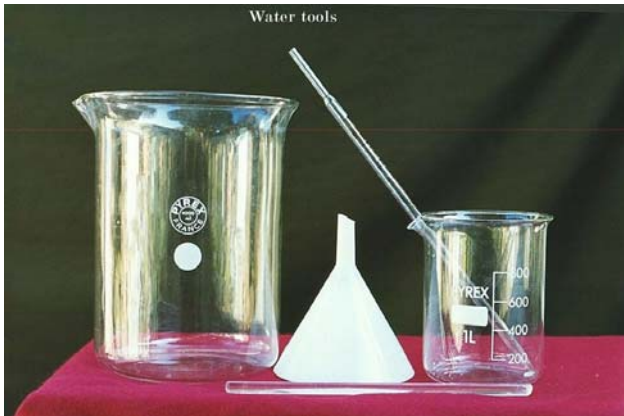
Fig.2 – Ustensiles d'eau, large b cher pour contenir l'eau charg e pendant l'entretien de la pile. Entonnoir et petit b cher pour faire le niveau d'eau de la pile. Burette pour enlever ou ajouter une petite quantit  d'eau de la pile et une baguette de verre pour remuer.
