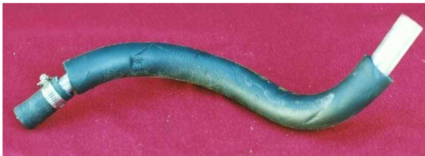
Fig.43 – Une vue du tuyau de la pile au moteur. Remarquez que le côté bouchon borgne du tuyau de caoutchouc n'a pas de collier de serrage et ainsi sera un ajustement libre sur le bouchon.
