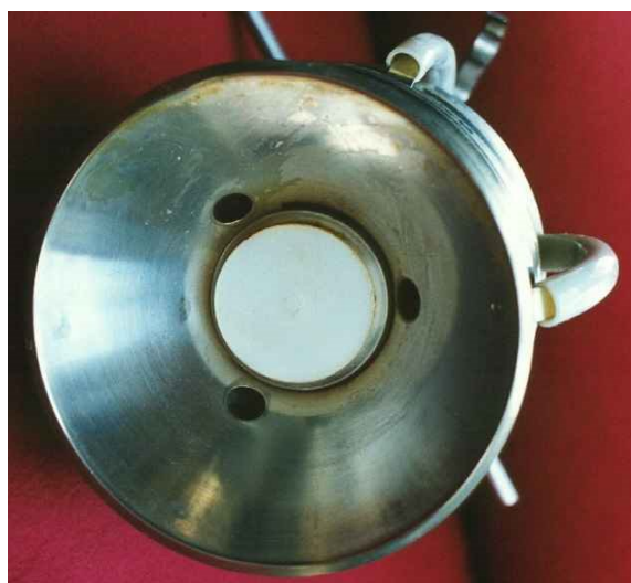
Fig.6 – Cuve de chargement. Une vue par en-dessous de la pile de cônes, montrant la tige centrale de Nylon qui est légèrement élargie pour soutenir le cône inférieur.
