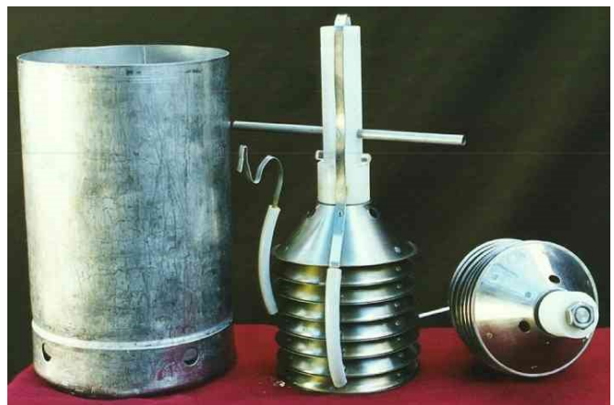
Fig.5 – Cuve de chargement. Vue générale des principaux composants. J'ai montré deux types différents de pile de cônes. La pile la plus proche de la cuve est celle utilisée dans ce manuel.
