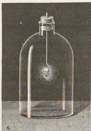
Fig. 55. — Combustion du diamant dans l'oxygène.
