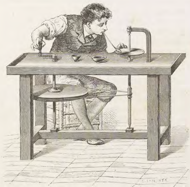
Fig. 150. — Appareil pour scier les pierres dures.
