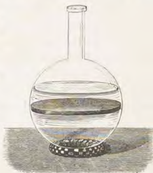
Fig. 92. — Disposition de Gannal pour la reproduction du diamant.
