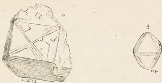
Abb. 9. Diamant aus granuliertem Eisen. Grösse 100 d.
