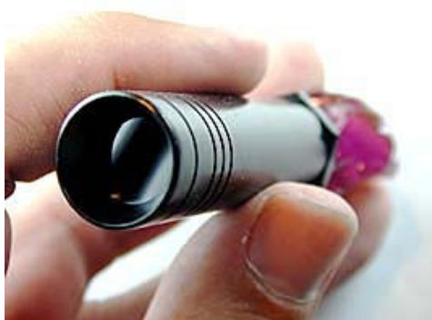
Calcit dichroscope, simuleret billede af en rubins karakteristiske pleochroism som det ser ud gennem et dichroskop
