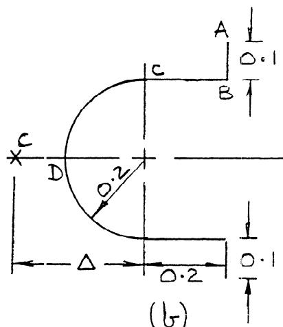
$$I_{NA} = 0.2t \times 0.2^2 \times 2 + \frac{t \times 0.1^3}{12} \times 2 + 0.1 \times t \times 0.15^2 \times 2$$
