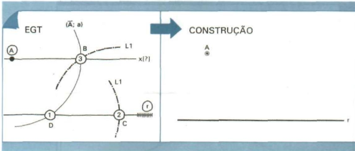
Neste problema você precisa "encaixar" o losango ABCD com um vértice em  $\bar{A}$  e um lado (DC) em  $\vec{r}$ .
