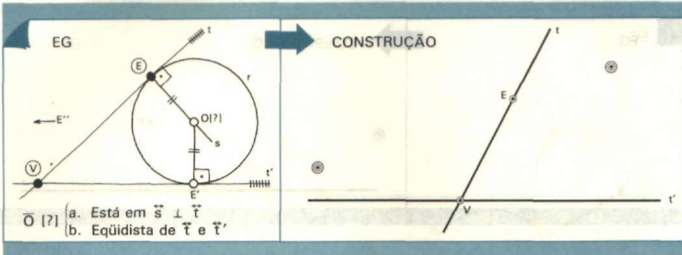
Um bom jeito de obter os pontos de tangência  $\bar{E}'$  e  $\bar{E}''$  em  $\vec{t}'$  é marcar  $VE' = VE'' = VE$ .
