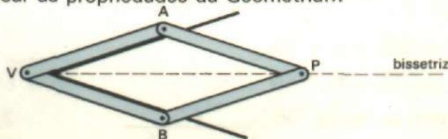
$\bar{A}$ ,  $\bar{V}$  e  $\bar{B}$  são três pontas-secas. Em  $\bar{P}$ , que é um ponto da bissetriz, coloca-se o grafite.
