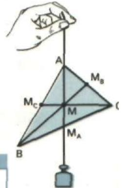
Se pendurarmos por  $\overline{B}$  ou por  $\overline{C}$ , o fio continuará passando por  $\overline{M}$ . Se espetarmos um alfinete em  $\overline{M}$ , o triângulo ficará em equilíbrio indiferente (na posição que o colocarmos ele ficará sem se mover).
