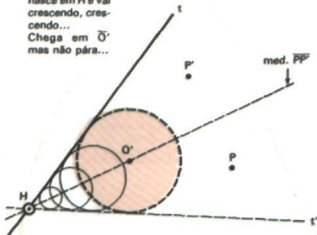
Quando "bater" em  $\bar{P}$  e  $\bar{P}'$  (ao mesmo tempo) será a 1.ª resposta (centro  $\bar{O}$ ) mas não pára... A "traseira" dela volta a "bater" em  $\bar{P}$  e  $\bar{P}'$  (2.ª resposta).
