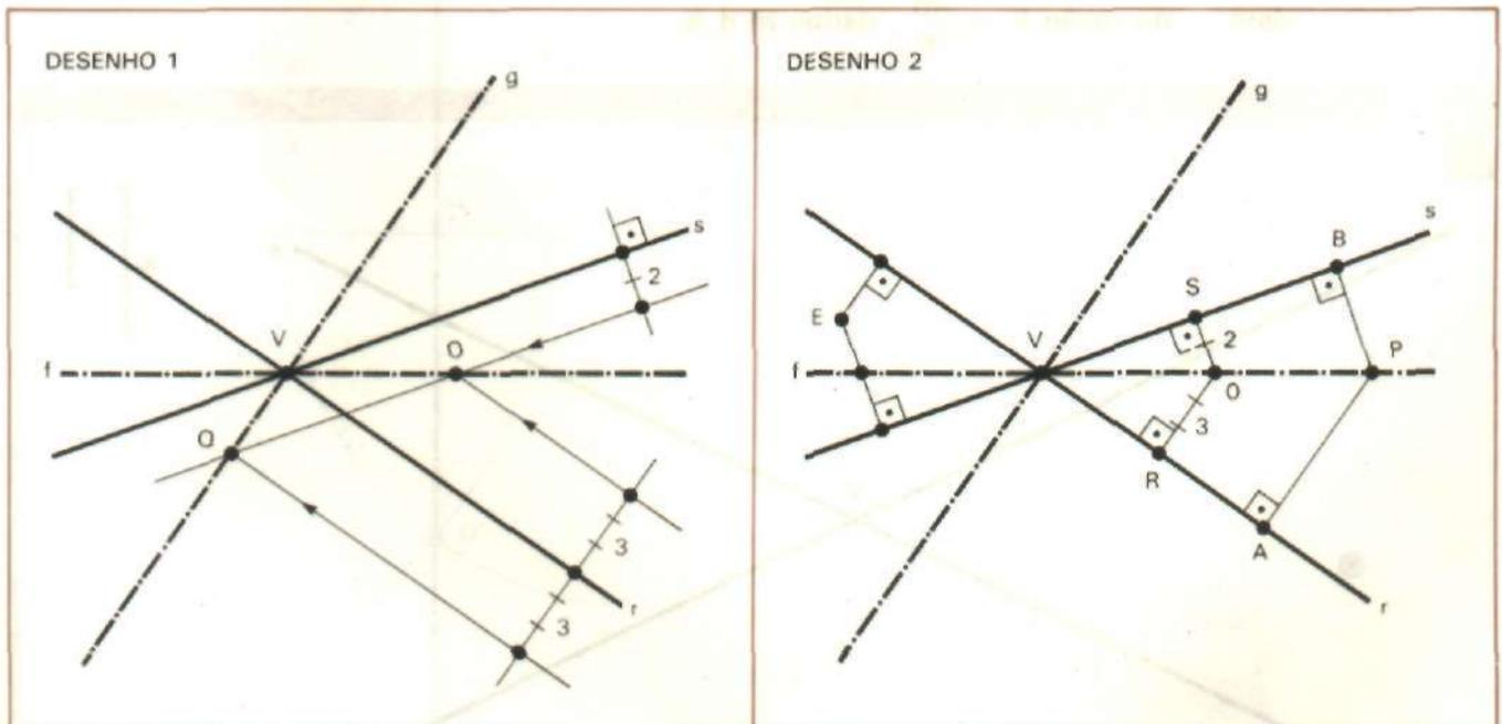
Como mostra o desenho 1, dadas  $\vec{r}$ ,  $\vec{s}$  e a razão  $k = \frac{m}{n}$  (no exemplo, fizemos  $k = \frac{3}{2}$ ), obtivemos  $\vec{O}$  e  $\vec{Q}$  e depois  $\vec{f}$  e  $\vec{g}$ .
