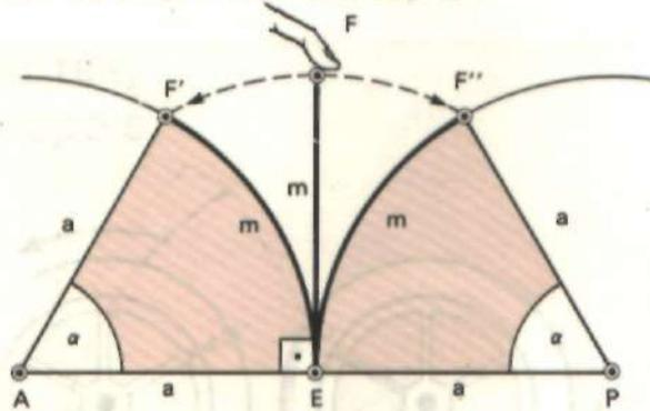
**218** Um arco tem 3 elementos inerentes, de medidas  $a$  (raio),  $\alpha$  (ângulo central) e  $m$  (comprimento).
