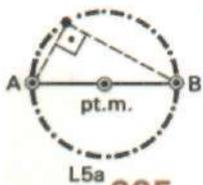
**L5a:** LG dos pontos que vêem  $\overline{AB}$  sob  $90^\circ$ .
