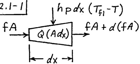
$$fA + h_P dx (T_{fi} - T) + Q(A dx) - [fA + d(fA)] = c_P \dot{T} A dx$$
