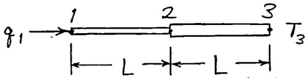
$$\frac{A_0 k}{L} \begin{bmatrix} 1 & -1 & 0 \\ -1 & 1+2 & -2 \\ 0 & -2 & 2 \end{bmatrix} \begin{bmatrix} T_1 \\ T_2 \\ T_3 \end{bmatrix} = \begin{bmatrix} q_1 \\ q_2 \\ q_3 \end{bmatrix}$$
