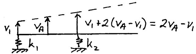
$$\begin{bmatrix} k_1 + k_2 & -2k_2 \\ -2k_2 & 4k_2 \end{bmatrix} \begin{Bmatrix} v_1 \\ v_A \end{Bmatrix} = \begin{Bmatrix} 0 \\ 0 \end{Bmatrix}$$
